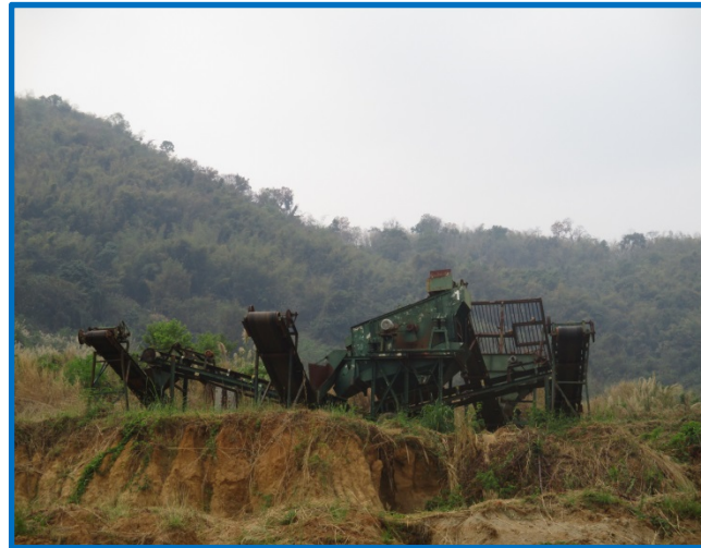
รูปที่ 2-22 เครื่องแยกแร่ของโครงการ
